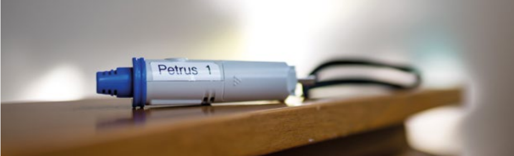
Ein kleines Gerät, der Datenlogger, kontrolliert und protokolliert Raumtemperatur und -feuchte, um genau auf den Bedarf hin zu heizen und unnötigen Wärmeverbrauch zu vermeiden.
